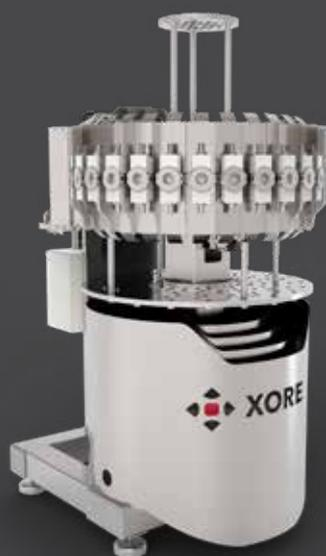
**Para muchas plantas concentradoras.** Boxray 24 consiste en un carrusel equipado con 24 celdas de medición que permiten a un solo analizador monitorizar múltiples pasos en el proceso, desde el mineral hasta el concentrado. Dado que cada caudal tiene su propia celda de circulación y medición, no hay riesgo de que las muestras se contaminen con otros caudales, lo que podría dañar los resultados del análisis.
