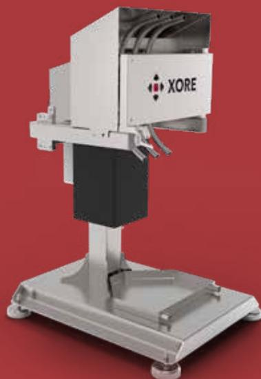
**Para la mayoría de las plantas concentradoras.** Boxray Compact tiene tres celdas de medición montadas en un trineo que se mueve hacia los lados. Dos de las celdas se utilizan para caudales y la tercera está adaptada para una muestra de referencia. Boxray Compact está equipado con un sistema múltiplex que permite hasta 16 caudales de muestra.
