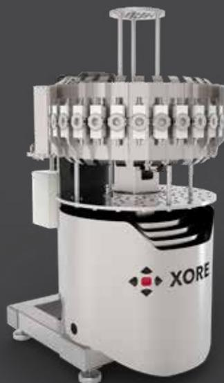
**Для многих обогатительных фабрик.** Voxray 24 состоит из вращающегося диска, оборудованного 24 измерительными камерами, что позволяет одному анализатору отслеживать несколько этапов процесса, от руды до концентрата. Так как для каждого потока выделяются отдельный контур и измерительная камера, отсутствует риск загрязнения образцов другими потоками, что может исказить результаты анализа.
